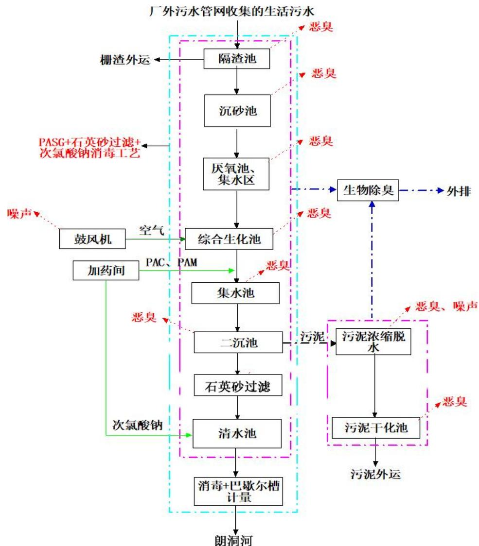
图 3.3.1 工艺流程图
