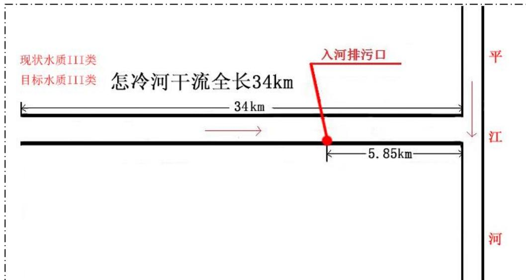
图 1.6.1 入河排污口所在水体与下游水功能区关系示意图
