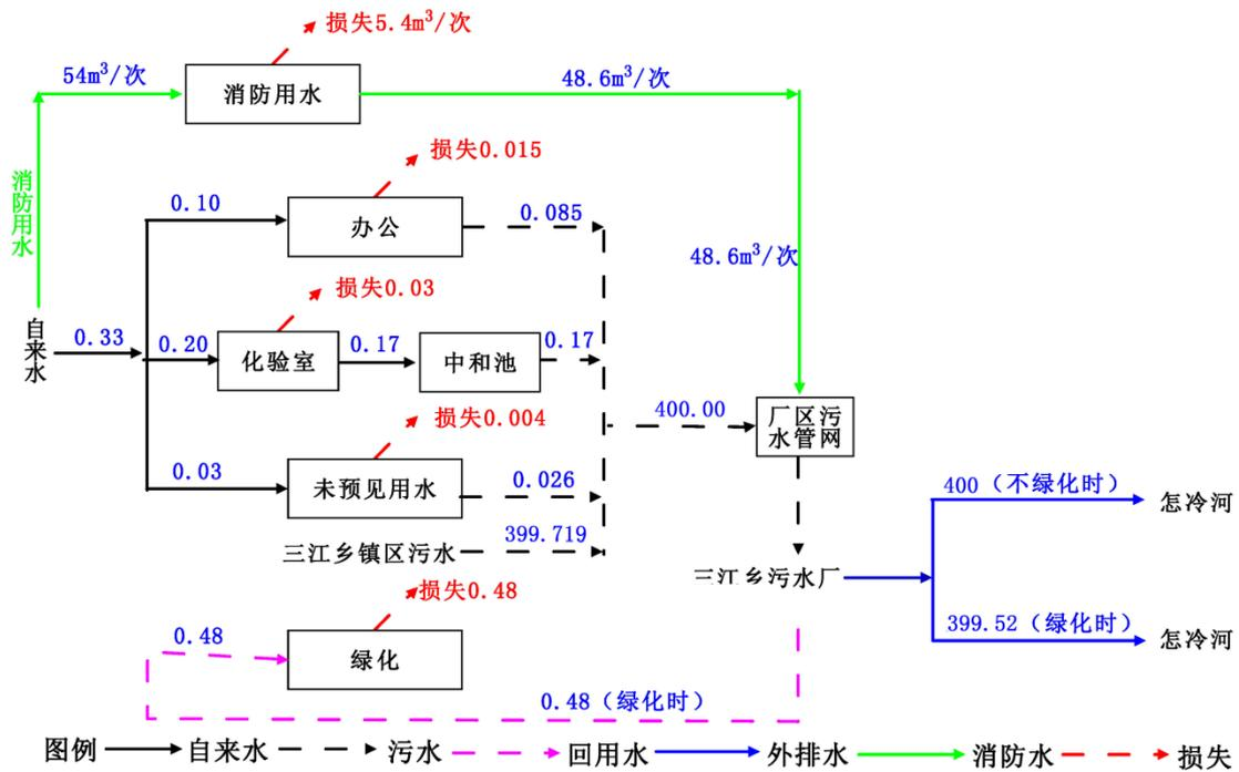
图3.4.1三江乡污水处理厂水平衡图 (单位: m<sup>3</sup>/d)
