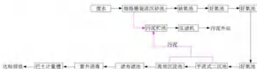
图 3.3-1 污水处理厂工艺流程图
