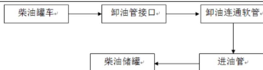
图 2-4 柴油卸油工艺流程图
